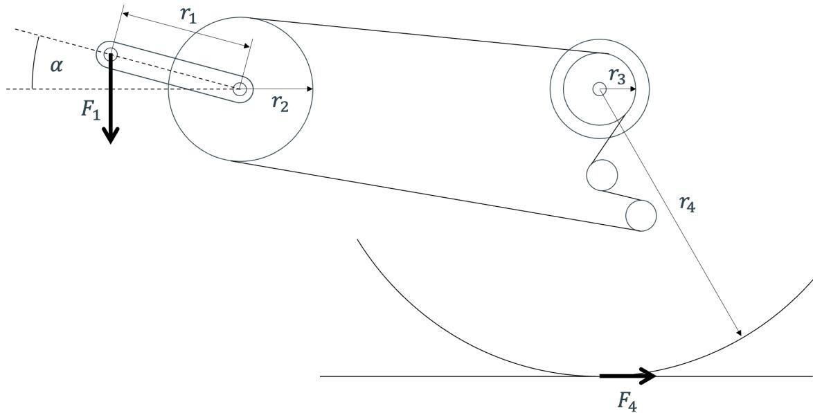
**Aufgabe:** Oben ist gezeigt, wie die Pedalenkraft  $F_1 = 400 \text{ N}$  über die Kurbel (vorderer Kranz), via Kette auf die Kassette (hinterer Kranz) und so auf das Hinterrad übertragen wird. Um die Rechnung zu vereinfachen wird Reibungsfreiheit angenommen.
